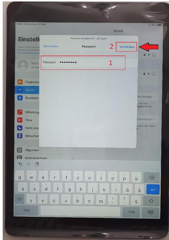
Hat das Verbinden geklappt, erscheint im Menü „WLAN“ ein Haken vor dem WLAN mit dem Sie nun verbunden sind. Sie können das Menü über den Home-Button unten in der Mitte des iPads verlassen und gelangen zur Startseite.
